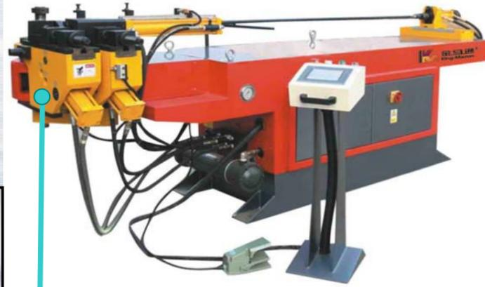
**TNC 型弯管机**是一款引进PINES 起源于1943年的弯管机技术。按目前行业要求可精确重复生产管件的高性能拉弯机，特别满足飞机上高难度、高精度的弯管需要。装备通过人机界面和PLC 程序控制的高效经济型弯管设备。弯曲角度、补偿角度、辅助轴运动时间等均通过人机对话数字设定和控制，程序永久保持于控制系统中，随时调用。通过手动送料转角可以实现三维管件的弯曲加工。这种机器通常使用在平面的或简单的三维管件弯曲加工。一次装夹自动完成一个弯曲半径一个弯头的弯曲加工，是普通管件弯曲加工大量选择的设备。如果增加手动小车，可以更方便实现一次装夹完成三维管件的弯曲加工。经过不断的技术更新，此款机器成为一款稳定，可靠，价格低廉的弯管机。同类设备在波音公司有使用。
