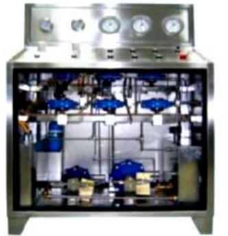
**PTC 导管压力测试清洗台**可提供1-10个独立工位的导管清洗、水压、气压、油压测试。导管外径尺寸3/16英寸至3 1/2英寸。
